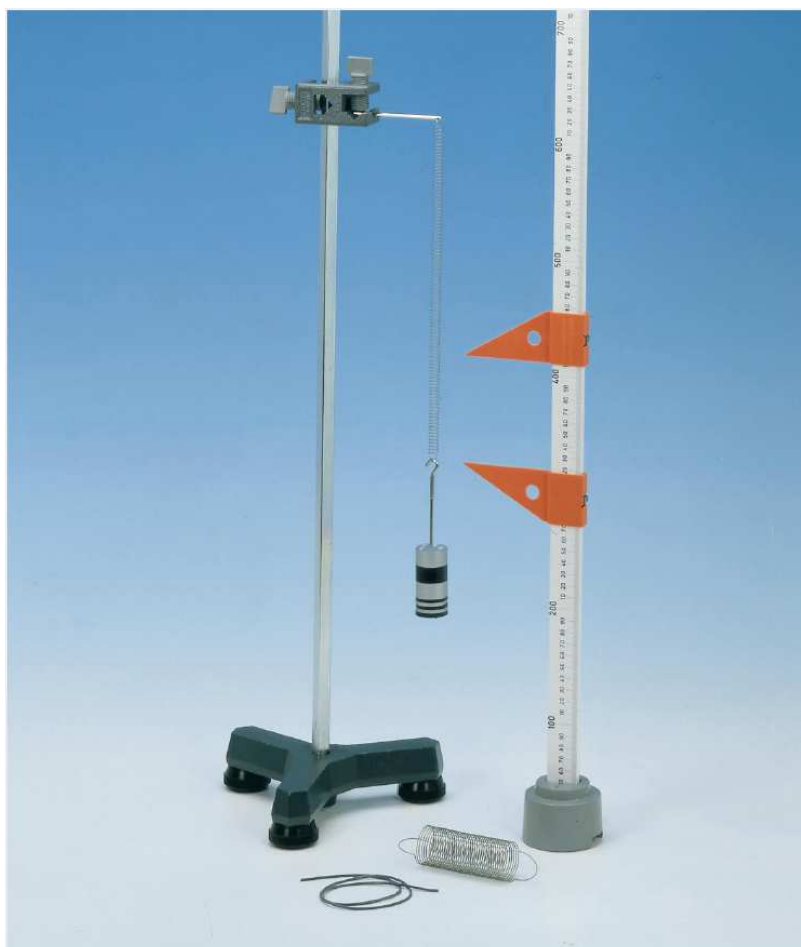
Rys.1. Układ doświadczalny badania wydłużenia sprężyny i oscylacji harmonicznych.
