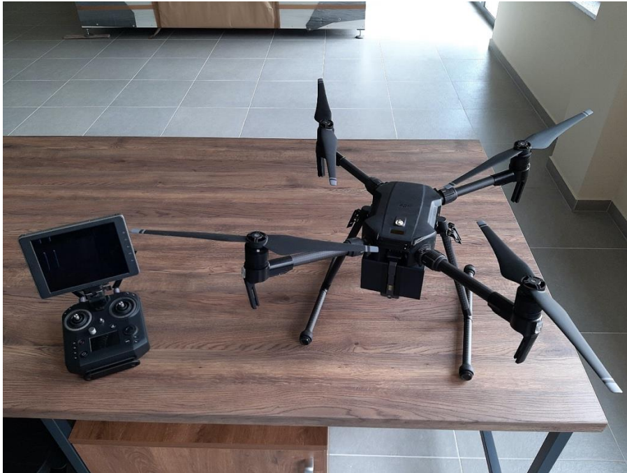
Foto 8. Dron DJI Matrice 200 z kamerą termowizyjną i elektroluminescencyjną do badania modułów PV. Foto LPNiOZE.
